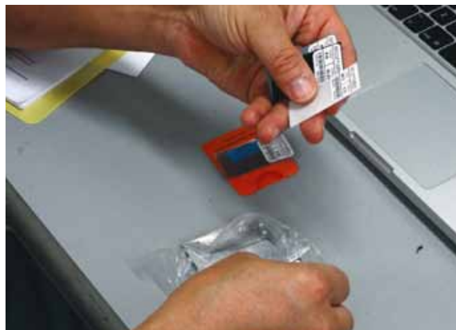
Kalibratiefolies voor de laagdiktemeter. Alles moet compleet en in goede conditie zijn.
